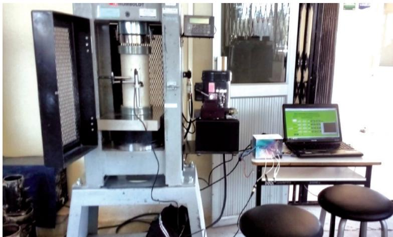
*Figura 8. Conexión del equipo portátil al compresómetro análogo y HMI.
